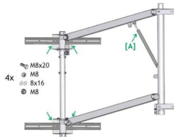
Montieren Sie die Schrauben an den 4 angegebenen Stellen.
