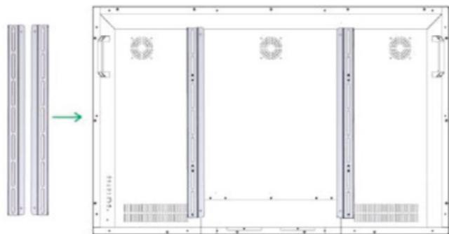
Platzieren Sie die vertikalen Profile hinter dem Bildschirm.
